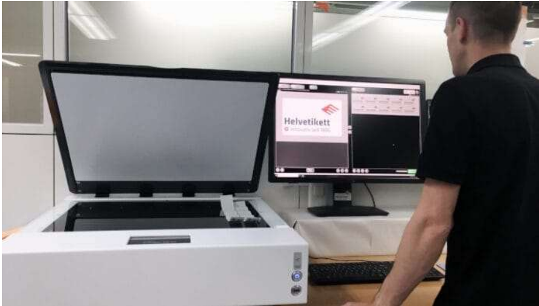
Einsatz des EyeC Profiler 600 zur Musterprüfung der Produktionsbögen.
